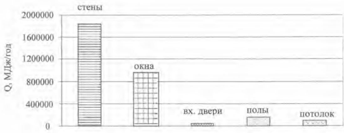
Рис.3.8. Структура распределения потерь тепла через отдельные ограждающие конструкции проектируемого здания
